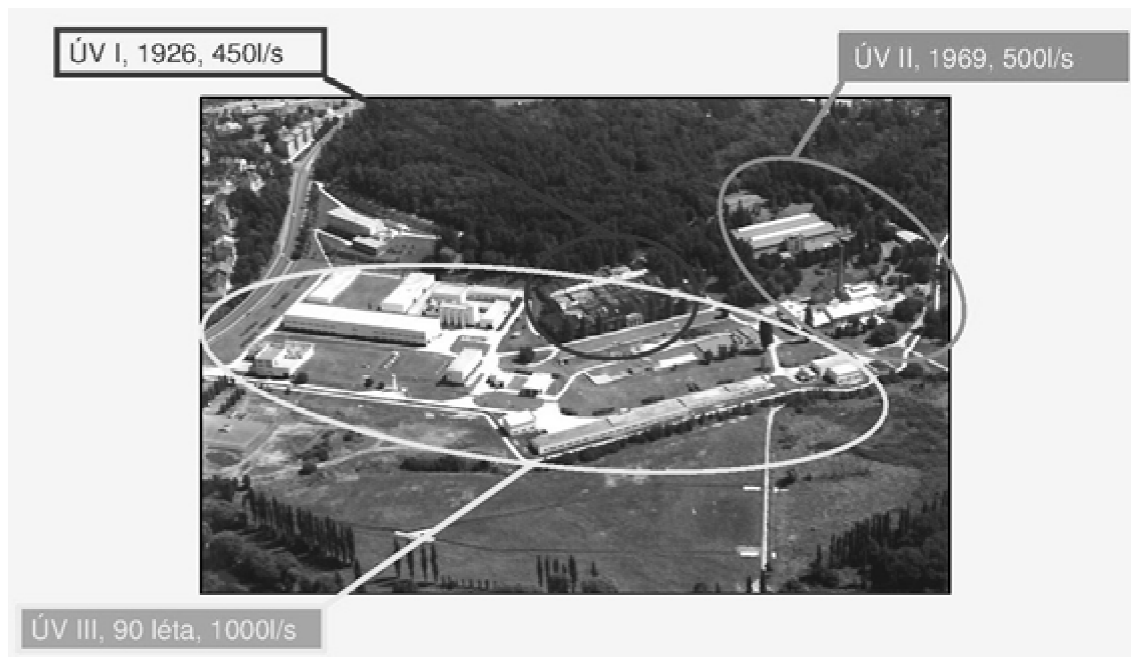
Obr. 2. Areál úpravný vody Plzeň – situační rozmístění
